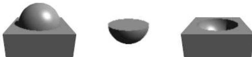
Obr. 13: Množinové operácie nad CSG telesami z obr. 12 – zjednotenie ( A \cup B ), prienik ( A \cap B ), rozdiel ( B - A ) (zľava).
